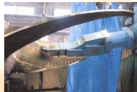
機械加工 (FPP) Blade Milling (FPP)
