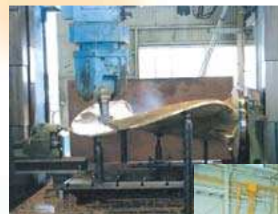
機械加工 (CPP) Blade Milling (CPP)
